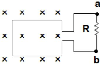
يكون اتجاه التيار الحثي في المقاومة R من (a → b) لأن تناقص شدة المجال المغناطيسي الخارجي يولد مجالاً مغناطيسياً حثياً بنفس اتجاه للممانعة النقص في التدفق المغناطيسي حسب قاعدة لنز داخل الملف المستطيل، وحسب قاعدة اليد اليمنى يكون اتجاه التيار الحثي مع عقارب الساعة أي من (a → b) في المقاومة R.
